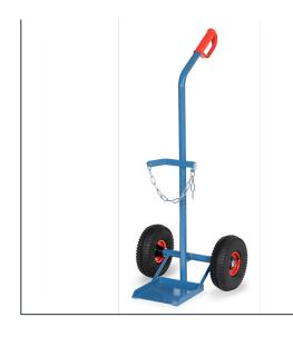
Stahlflaschenkarre aus Stahlrohr geschweißt, pulverbeschichtet blau RAL 5007. Flaschenhalterungen mit Kettensicherung. Räder mit Luftbereifung, Naben mit Rollenlager.
