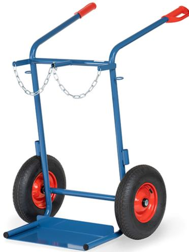
Stahlflaschenkarre aus Stahlrohr geschweißt, pulverbeschichtet blau RAL 5007. Flaschenhalterungen mit Kettensicherung. Räder mit Luftbereifung, Naben mit Rollenlager. Schweißdrahtköcher an beiden Holmen.
