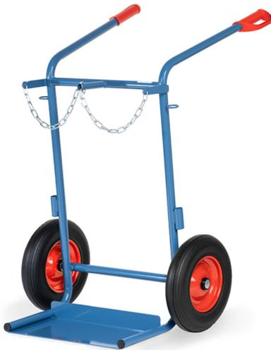
Stahlflaschenkarre aus Stahlrohr geschweißt, pulverbeschichtet blau RAL 5007. Flaschenhalterungen mit Kettensicherung. Räder mit Vollgummibereifung, Naben mit Rollenlager. Schweißdrahtköcher an beiden Holmen.
