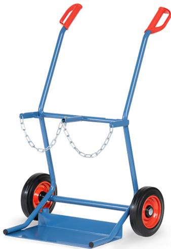
Stahlflaschenkarre aus Stahlrohr geschweißt, pulverbeschichtet blau RAL 5007. Flaschenhalterungen mit Kettensicherung. Räder mit Vollgummibereifung, Naben mit Rollenlager.
