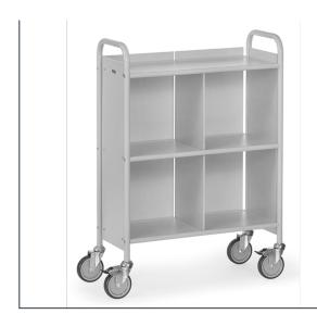
Baukasten-System: verschraubte Stahlrohr-Konstruktion, pulverbeschichtet in lichtgrau RAL 7035. Böden, Seitenwände, Trenn- und Längswand aus Holzwerkstoffplatten, hellgrau. 4 Lenkrollen, Räder mit TPE-Bereifung, elastisch und leicht laufend, spurlos. Naben mit Gleitlager. 2 Lenkrollen mit Feststeller, gemäß der Europäischen Norm EN 1757-3 (Sicherheit von Plattformwagen). Zerlegte Anlieferung, leichte Selbstmontage. Gesamtlänge: 810 mm, Gesamtbreite: 385 mm, Tragkraft pro Etage 50 kg.
