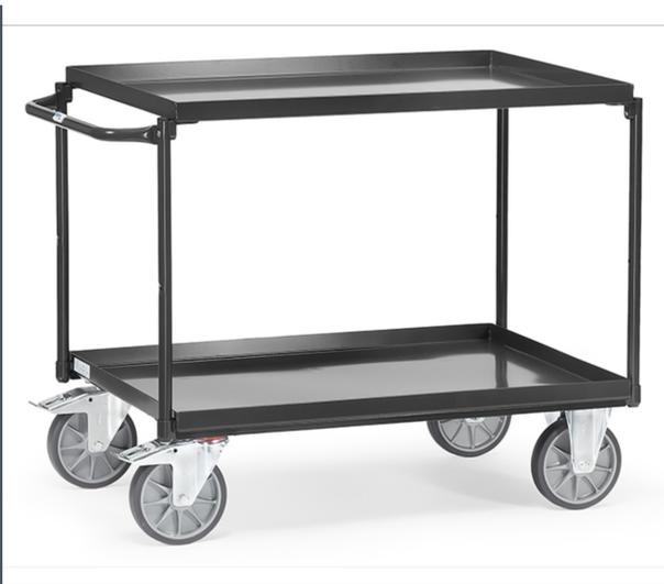
Stahlkonstruktion geschweißt. Mit 2 Stahlblechwannen. Stahlrohrbügel und Stahlblechwannen verschraubt. Wannen öldicht, Rand 40 mm hoch. Pulverbeschichtet RAL 7016 anthrazitgrau. Schiebegriff waagrecht. 2 Lenk- und 2 Bockrollen, TPE-Bereifung, Naben mit Rillenkugellager. Feststeller an den Lenkrollen, gemäß EN 1757-3 (Sicherheit von Plattformwagen). Tragkraft obere Ladefläche 200 kg.
