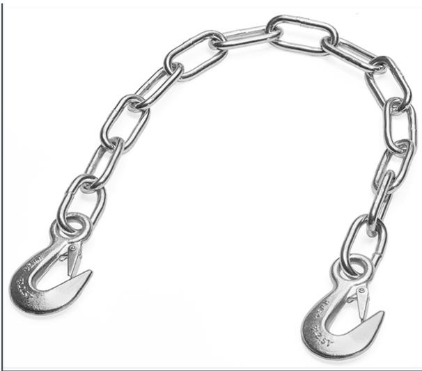
Gliederkette als Abrutschsicherung mit Abschlepphaken. Die Kette besteht aus 18 Gliedern und ist beidseitig mit Abschlepphaken ausgestattet. Die Gliedergröße beträgt 8 x 52 mm. Geprüft nach DIN 763, Bruchlast 25 KN.
