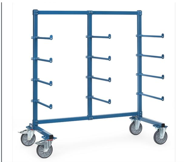
Rahmen aus stabilem Quadratrohr. Rollen-Traversen, Pfosten und Streben durch kräftige Schraubchellen verbunden. Tragarme aus Stahlrohr 27 mm Ø mit Schraubchellen. 12 Tragarme einseitig mit Abrollsicherung. Nutzlänge 600 mm, Tragkraft pro Etage 80 kg. Pulverbeschichtet blau RAL 5007. 2 Lenk- und 2 Bockrollen, TPE-Bereifung, Naben mit Rillenkugellager. Feststeller an den Lenkrollen, gemäß der Europäischen Norm EN 1757-3 (Sicherheit von Plattformwagen).
