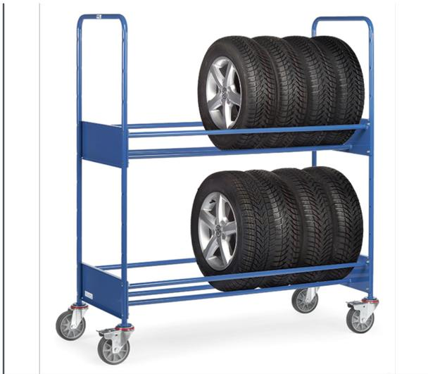
Stahlrohr-Konstruktion, verschraubt, pulverbeschichtet blau RAL 5007. mit TPE-Bereifung, Naben mit Rillenkugellager, Feststeller an den Lenkrollen. Reifenträger variabel im Raster von 150 mm mit Stirnbügeln verschraubbar.
