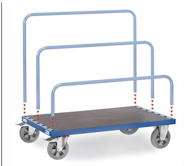
Profilstahl und Stahlrohr geschweißt, pulverbeschichtet, Holzplattform. 7 Verstellmöglichkeiten für Einsteckbügel. Bügelabstand licht 90 mm, 2 Lenk- und 2 Bockrollen, Lenkrollen mit Feststeller gemäß der Europäischen Norm EN 1757-3 (Sicherheit von Plattformwagen). Vollgummi-Elastic-Bereifung, blaugrau "spurlos", Naben mit Kugellager. Lieferung ohne Bügel.
