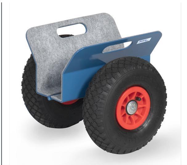
Stahl-Schweißkonstruktion, pulverbeschichtet blau RAL 5007, Klemmflächen mit Filzbelag. Sichere Klemmung durch das Gewicht des Ladegutes auf die Klappkonstruktion. Reifen mit Vollgummibereifung. Maximale Klemmbreite 30-95 mm (für Fenster geeignet).
