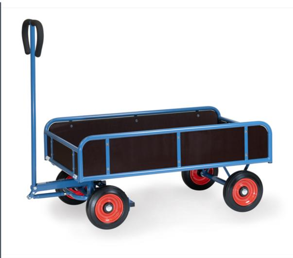
Aus Stahlrohr geschweißt, pulverbeschichtet brillantblau RAL 5007. Geländer 180/250 mm hoch, Ladefläche und Wände aus wasserfestem Sperrholz. Drehschemel-Lenkung mit Deichsel und Handgriff. Deichsel mit Sicherheitshandgriff mit Softgrip-Bezug und automatischer gedämpfter Rückstellung in Ruheposition. Räder mit Vollgummibereifung, Naben mit Rollenlager. Automatische Feststellbremse auf die Vorderräder wirkend. Entspricht der Europäischen Norm EN 1757-3.
