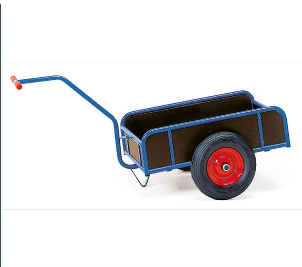
Handwagen aus Stahlrohr geschweißt, pulverbeschichtet, brillantblau RAL 5007. Deichsel anschraubbar, Ladefläche aus wasserfestem Sperrholz. Mit 4 Wänden aus wasserfestem Sperrholz, 180/250 mm hoch. Räder mit Vollgummibereifung, Naben mit Rollenlager.
