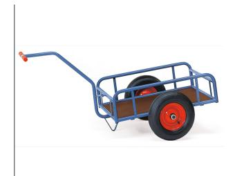
Handwagen aus Stahlrohr geschweißt, pulverbeschichtet, brillantblau RAL 5007. Geländer 180/250 mm hoch. Deichsel anschraubbar, Ladefläche aus wasserfestem Sperrholz. Räder mit Luftbereifung, Naben mit Rollenlager.
