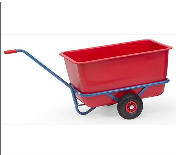
Leichter und sehr handlicher Handwagen aus Stahlrohr geschweißt, pulverbeschichtet blau RAL 5007. Deichsel anschraubbar. Mit herausnehmbarer roter Kunststoffmulde (200 Liter Inhalt). Räder mit Vollgummibereifung, Naben mit Rollenlager. Zerlegte Anlieferung. Leichte Selbstmontage.
