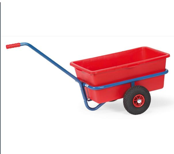
Leichter und sehr handlicher Handwagen aus Stahlrohr geschweißt, pulverbeschichtet blau RAL 5007. Deichsel anschraubbar. Mit herausnehmbarer roter Kunststoffmulde (90 Liter Inhalt). Räder mit Luftbereifung, Naben mit Rollenlager. Zerlegte Anlieferung. Leichte Selbstmontage.
