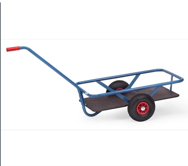
Leichter und sehr handlicher Handwagen aus Stahlrohr geschweißt, pulverbeschichtet blau RAL 5007. Deichsel anschraubbar. Ladefläche aus wasserfestem Sperrholz. Räder mit Vollgummibereifung, Naben mit Rollenlager. Zerlegte Anlieferung. Leichte Selbstmontage.
