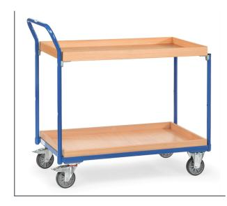
Stahlrohr und Profilstahl geschweißt, pulverbeschichtet brillantblau RAL 5007. Schraubkonstruktion. 2 Kästen aus Holzwerkstoffplatte mit 45 mm hohem Rand, Oberfläche Buchendekor. Schiebegriff hochstehend. 2 Lenk- und 2 Bockrollen, TPE-Bereifung, Naben mit Rillenkugellager. Feststeller an den Lenkrollen, gemäß der Europäischen Norm EN 1757-3 (Sicherheit von Plattformwagen). Tragkraft obere Ladefläche 80 kg. Kasten-Innenabmessungen obere Etage: 965 x 555 x 45 mm.
