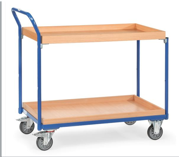
Stahlrohr und Profilstahl geschweißt, pulverbeschichtet brillantblau RAL 5007. Schraubkonstruktion. 2 Kästen aus Holzwerkstoffplatte mit 45 mm hohem Rand, Oberfläche Buchendekor. Schiebegriff hochstehend. 2 Lenk- und 2 Bockrollen, TPE-Bereifung, Naben mit Rillenkugellager. Feststeller an den Lenkrollen, gemäß der Europäischen Norm EN 1757-3 (Sicherheit von Plattformwagen). Tragkraft obere Ladefläche 80 kg. Kasten-Innenabmessungen obere Etage: 815 x 455 x 45 mm.
