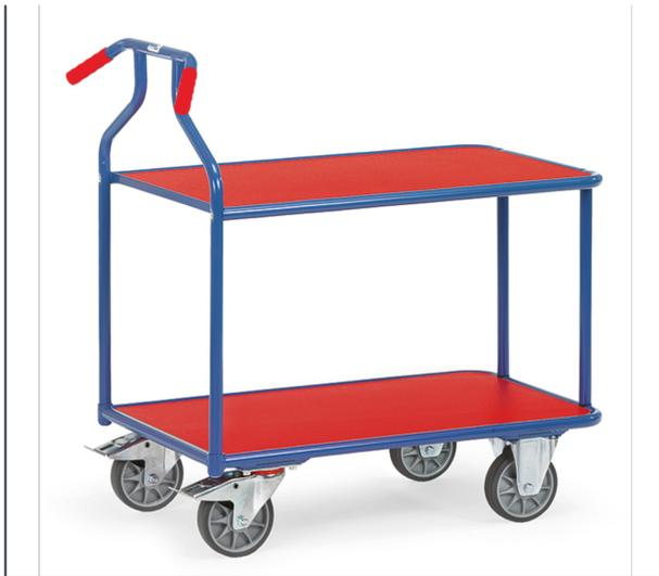
Stahlrohr-Konstruktion, pulverbeschichtet, dauerhaft oberflächengeschützt, schlag- und kratzfest. 2 Böden Holzwerkstoffplatte mit roter Kunststoffoberfläche. 2 Lenk- und 2 Bockrollen, TPE-Bereifung, Naben mit Rillenkugellager. Feststeller an den Lenkrollen, gemäß der Europäischen Norm EN 1757-3 (Sicherheit von Plattformwagen). Tragkraft obere Ladefläche 200 kg.
