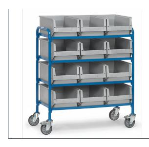
Baukasten-System: Stahlrohr- und Profilstahl geschweißt, pulverbeschichtet blau RAL 5007, Schraubkonstruktion. 4 Etagen mit Holzwerkstoffplatten, Rand 10 mm hoch und 12 Sichtlagerkästen (LxBxH: 500/450 x 310 x 200 mm). Tragkraft pro Ladefläche 60 kg. 4 Lenkrollen, TPE-Bereifung, Naben mit Rillenkugellager. 2 Stück mit Feststeller, gemäß der Europäischen Norm EN 1757-3 (Sicherheit von Plattformwagen). Zerlegte Anlieferung.
