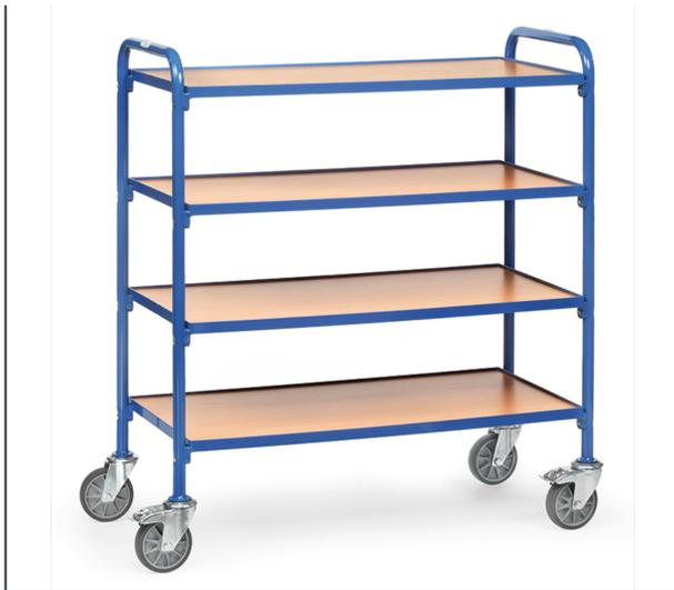
Baukasten-System: Stahlrohr- und Profilstahl geschweißt, pulverbeschichtet blau RAL 5007, Schraubkonstruktion. 4 Etagen mit Holzwerkstoffplatten, Rand 10 mm hoch. Tragkraft pro Ladefläche 60 kg. 4 Lenkrollen, TPE-Bereifung, Naben mit Rillenkugellager. 2 Stück mit Feststeller, gemäß der Europäischen Norm EN 1757-3 (Sicherheit von Plattformwagen). Zerlegte Anlieferung.
