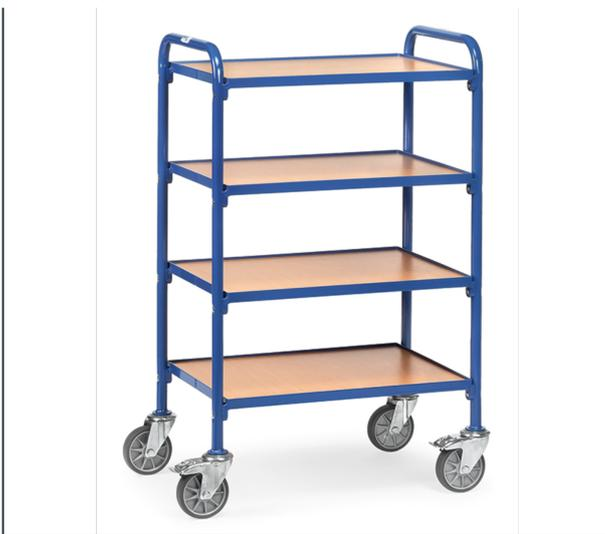
Baukasten-System: Stahlrohr- und Profilstahl geschweißt, pulverbeschichtet blau RAL 5007, Schraubkonstruktion. 4 Etagen mit Holzwerkstoffplatten, Rand 10 mm hoch. Tragkraft pro Ladefläche 60 kg. 4 Lenkrollen, TPE-Bereifung, Naben mit Rillenkugellager. 2 Stück mit Feststeller, gemäß der Europäischen Norm EN 1757-3 (Sicherheit von Plattformwagen). Zerlegte Anlieferung.
