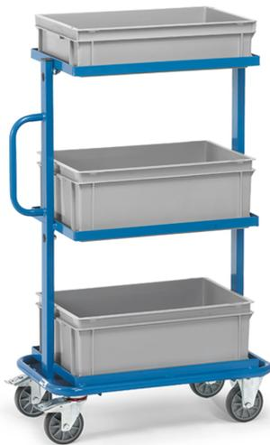
Stahlrohr- und Profilstahl-Konstruktion, pulverbeschichtet, blau RAL 5007. Mit 3 Kunststoffkästen: 1 St. 600 x 400 x 145 mm, 2 St. 600 x 400 x 220 mm. 2 Lenk- und 2 Bockrollen, TPE-Bereifung, Naben mit Rillenkugellager. Feststeller an den Lenkrollen, gemäß der Europäischen Norm EN 1757-3 (Sicherheit von Plattformwagen). Tragkraft obere und mittlere Ladefläche 50 kg.
