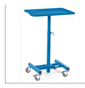
Für Kunststoffkästen, Stahlblechkästen, Drahtkörbe usw., höhenverstellbar und fahrbar. Profilstahl-/Rohrkonstruktion mit Stahlblechplattform. Stahlblechplattform mit allseitigem Rand 20 mm hoch. Nicht neigbar, höhenverstellbar im Raster von 25 mm. Pulverbeschichtet blau RAL 5007. 4 Lenkrollen, Naben mit Gleitlagerung, 2 davon mit Feststeller gemäß der Europäischen Norm EN 1757-3 (Sicherheit von Plattformwagen).
