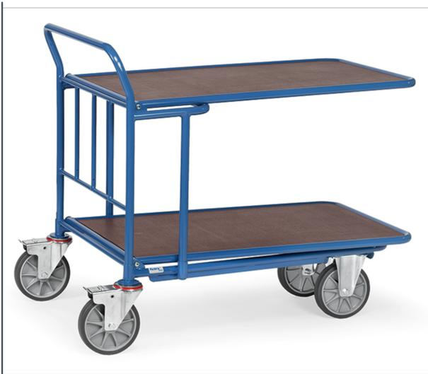
C+C-Wagen (Baumarktwagen / Einkaufswagen) - Stahlrohrkonstruktion, pulverbeschichtet, 2 Ladeflächen mit rutschsicherer Siebdruckplatte aus wasserfestem Sperrholz. Tragkraft oberer Boden 80 kg. 2 Lenk- und 2 Bockrollen, TPE-Bereifung, Naben mit Rillenkugellager. Feststeller an den Lenkrollen, gemäß der Europäischen Norm EN 1757-3 (Sicherheit von Plattformwagen). Ineinanderschiebbare Wagen, dadurch 75% Stellraum-Einsparung.
