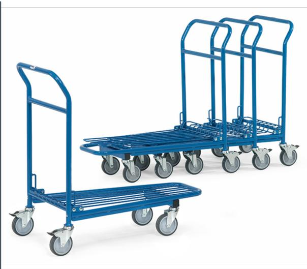
Lagerwagen aus Stahlrohrkonstruktion und Ladefläche mit Drahtgitter. Pulverbeschichtet, brillantblau RAL 5007. Plattform: konisch und leicht geneigt. 4 Lenkrollen, TPE-Bereifung, Naben mit Gleitlager. 2 Lenkrollen mit Feststeller, gemäß der Europäischen Norm (Sicherheit von Plattformwagen). Ineinanderschiebbare Wagen, 75% Stellraum-Einsparung. Handlich und wendig, für schnelle Transporte und Kommissionierung. Zerlegte Anlieferung, leichte Selbstmontage.
