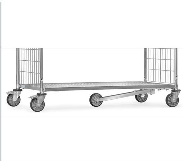
Ein 5. TPE-Rad 125 mm Ø an einem federbeaufschlagten Profilstahlarm als Führungsrolle für guten Geradeauslauf. Drehen auf der Stelle ist trotzdem möglich.
