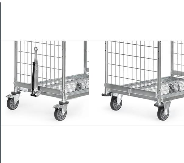
Zum Fahren mit max. 3 Kommissionierwagen im Verbund. Anstelle der 2 Lenkrollen ohne Feststeller werden 2 Bockrollen verbaut. Deichsel aus Flachstahl profiliert. Stellt sich mittels Gasdruckfeder selbsttätig in senkrechte Ruheposition. Stabiler profilierter Kupplungsbolzen an der gegenüberliegenden Stirnseite. Verbinden durch Fußbetätigung möglich. Maximale Zuggeschwindigkeit 6 km/h. Nicht mit Trittstufen kombinierbar.
