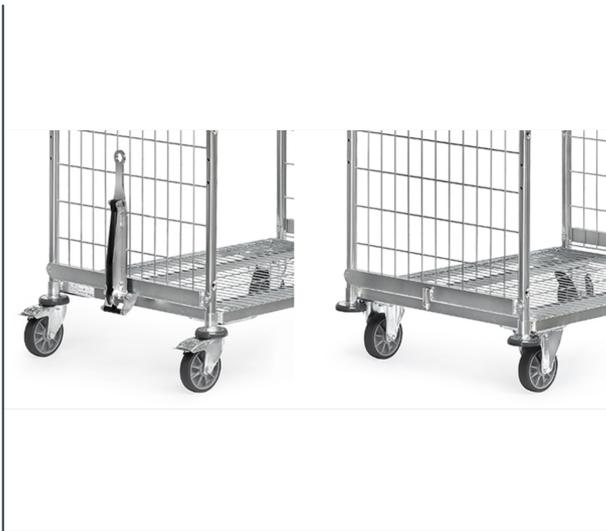
Zum Fahren mit max. 3 Kommissionierwagen im Verbund. Anstelle der 2 Lenkrollen ohne Feststeller werden 2 Bockrollen verbaut. Deichsel aus Flachstahl profiliert. Stellt sich mittels Gasdruckfeder selbsttätig in senkrechte Ruheposition. Stabiler profilierter Kupplungsbolzen an der gegenüberliegenden Stirnseite. Verbinden durch Fußbetätigung möglich. Maximale Zuggeschwindigkeit 6 km/h. Nicht mit Trittstufen kombinierbar.
