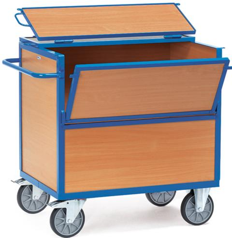
Stahlrohr und Profilstahl geschweißt, pulverbeschichtet blau RAL 5007. Boden aus Holzwerkstoffplatte, Oberfläche Buchendekor. Winkelstahl-Konstruktion. Wände und Deckel aus Holzwerkstoffplatte, Oberfläche Buchendekor. Deckel 2-fach klappbar. Ringösen für Vorhängeschlösser. 2 Lenk- und 2 Bockrollen, TPE-Bereifung, Naben mit Rillenkugellager. Feststeller an den Lenkrollen, gemäß der Europäischen Norm EN 1757-3 (Sicherheit von Plattformwagen). Zerlegte Anlieferung. Nutzhöhe: 806 mm.
