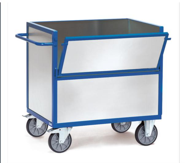
Stahlrohr und Profilstahl geschweißt, pulverbeschichtet blau RAL 5007. Boden aus Stahlblech, pulverbeschichtet. Winkelstahl-Konstruktion. Wände aus verzinktem Stahlblech, eingeklebt. 2 Lenk- und 2 Bockrollen, TPE-Bereifung, Naben mit Rillenkugellager. Feststeller an den Lenkrollen, gemäß der Europäischen Norm EN 1757-3 (Sicherheit von Plattformwagen). Zerlegte Anlieferung. Nutzhöhe: 816 mm.
