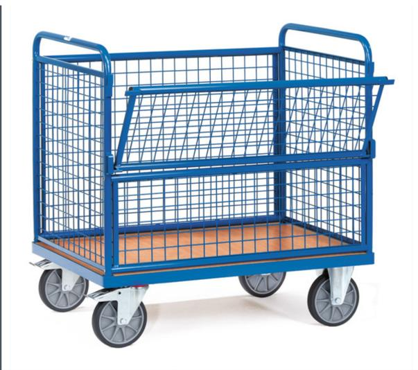
Stahlrohr und Profilstahl geschweißt, pulverbeschichtet blau RAL 5007. Boden aus Holzwerkstoffplatte, Oberfläche Buchendekor. Verschraubte Baukasten-Ausführung: Mit Stahlrohr-Aufbau, Drahtgitter 50 x 50 x 4 mm eingeschweißt 2 Lenk- und 2 Bockrollen, TPE-Bereifung, Naben mit Rillenkugellager. Feststeller an den Lenkrollen, gemäß der Europäischen Norm EN 1757-3 (Sicherheit von Plattformwagen). Zerlegte Anlieferung. Nutzhöhe: 700 mm.
