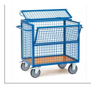
Stahlrohr und Profilstahl geschweißt, pulverbeschichtet blau RAL 5007. Boden aus Holzwerkstoffplatte, Oberfläche Buchendekor. Winkelstahl-Konstruktion. Drahtgitter 50 x 50 x 4 mm eingeschweißt. Deckel aus Drahtgitter, 2-fach klappbar. Ringösen für Vorhängeschlösser. 2 Lenk- und 2 Bockrollen, TPE-Bereifung, Naben mit Rillenkugellager. Feststeller an den Lenkrollen, gemäß der Europäischen Norm EN 1757-3 (Sicherheit von Plattformwagen). Zerlegte Anlieferung. Nutzhöhe: 806 mm.
