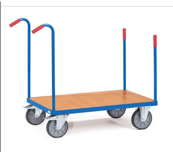
Stahlrohr und Profilstahl geschweißt, pulverbeschichtet RAL 5007, Plattform Holzwerkstoffplatte, Oberfläche Buchendekor. 2 Lenk- und 2 Bockrollen, TPE-Bereifung, Naben mit Rillenkugellager. Feststeller an den Lenkrollen, gemäß der Europäischen Norm EN 1757-3 (Sicherheit von Plattformwagen).
