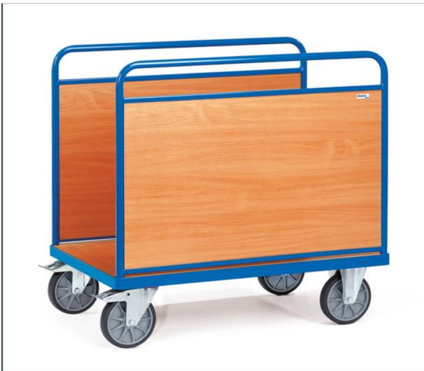
Stahlrohr und Profilstahl geschweißt, pulverbeschichtet RAL 5007, Plattform Holzwerkstoffplatte, Oberfläche Buchendekor. Mit 2 Wänden aus Holzwerkstoffplatten, Oberfläche Buchendekor, Wandhöhe 600/750 mm. 2 Lenk- und 2 Bockrollen, TPE-Bereifung, Naben mit Rillenkugellager. Feststeller an den Lenkrollen, gemäß der Europäischen Norm EN 1757-3 (Sicherheit von Plattformwagen).
