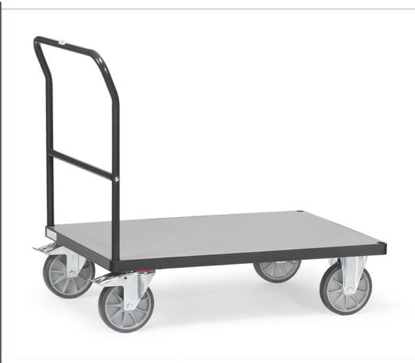
Schiebebügelwagen aus Stahlrohr und Profilstahl geschweißt, pulverbeschichtet anthrazitgrau RAL 7016. Plattform Holzwerkstoffplatte, Oberfläche mittelgrau. 2 Lenk- und 2 Bockrollen, TPE-Bereifung, Naben mit Rillenkugellager. Feststeller an den Lenkrollen, gemäß der Europäischen Norm EN 1757-3 (Sicherheit von Plattformwagen).
