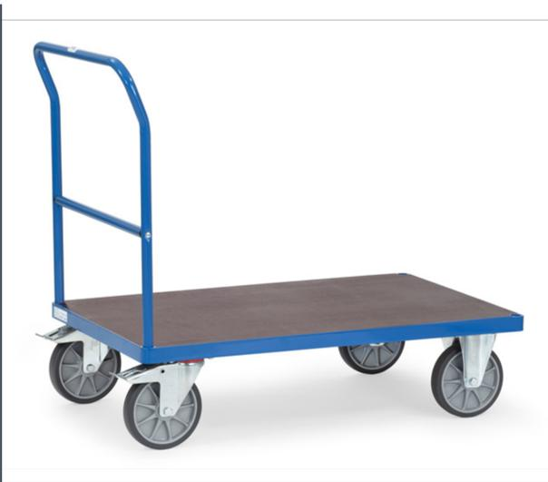
Schiebebügelwagen aus Stahlrohr und Profilstahl geschweißt, pulverbeschichtet brillantblau RAL 5007. Plattform mit rutschsicherer Siebdruckplatte aus wasserfestem Sperrholz. 2 Lenk- und 2 Bockrollen, TPE-Bereifung, Naben mit Rillenkugellager. Feststeller an den Lenkrollen, gemäß der Europäischen Norm EN 1757-3 (Sicherheit von Plattformwagen).
