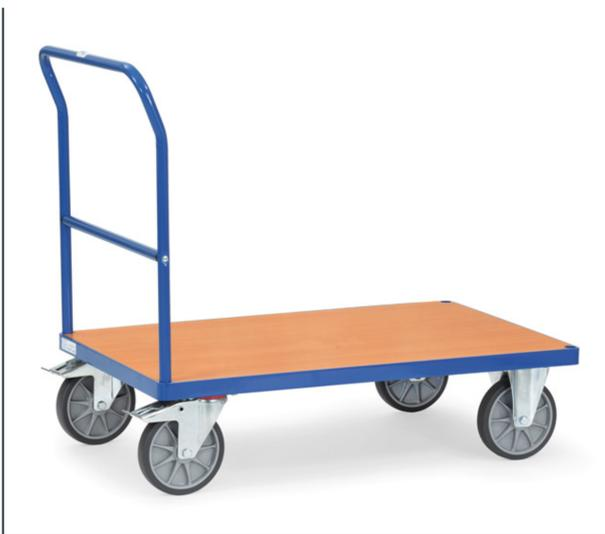
Schiebebügelwagen aus Stahlrohr und Profilstahl geschweißt, pulverbeschichtet brillantblau RAL 5007. Plattform mit Holzwerkstoffplatte, Oberfläche Buchendekor. 2 Lenk- und 2 Bockrollen, TPE-Bereifung, Naben mit Rillenkugellager. Feststeller an den Lenkrollen, gemäß der Europäischen Norm EN 1757-3 (Sicherheit von Plattformwagen).
