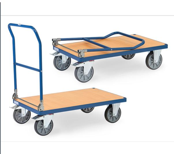
Klappwagen aus Stahlrohr und Profilstahl geschweißt, pulverbeschichtet brillantblau RAL 5007. Ladefläche aus Holzwerkstoffplatte, Oberfläche Buchendekor. Schiebebügel auf Plattform klappbar. 2 Lenk- und 2 Bockrollen, TPE-Bereifung (spurlos), Naben mit Rillenkugellager. Feststeller an den Lenkrollen, gemäß der Europäischen Norm EN 1757-3 (Sicherheit von Plattformwagen).
