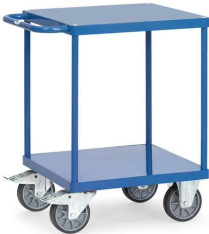
Stahlrohr und Profilstahl geschweißt, pulverbeschichtet RAL 5007. 2 Plattformen aus Stahlblech, bündig im Rahmen, sauber eingeschweißt, ebenfalls pulverbeschichtet RAL 5007. 2 Lenk- und 2 Bockrollen, TPE-Bereifung, Naben mit Rillenkugellager. Feststeller an den Lenkrollen, gemäß der Europäischen Norm EN 1757-3 (Sicherheit von Plattformwagen). Tragkraft obere Ladefläche 200 kg.
