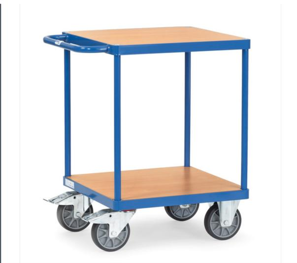
Stahlrohr und Profilstahl geschweißt, pulverbeschichtet RAL 5007. 2 Plattformen aus Holzwerkstoffplatte, Oberfläche Buchendekor. 2 Lenk- und 2 Bockrollen, TPE-Bereifung, Naben mit Rillenkugellager. Feststeller an den Lenkrollen, gemäß der Europäischen Norm EN 1757-3 (Sicherheit von Plattformwagen). Tragkraft obere Ladefläche 200 kg.
