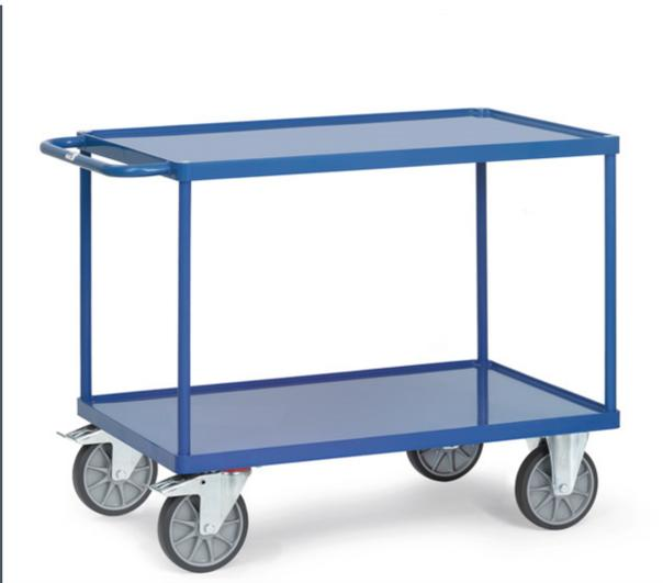
Stahlrohr und Profilstahl geschweißt, pulverbeschichtet RAL 5007. 2 Stahlblechwannen mit 10 mm hohem Rand, öldicht verschweißt, pulverbeschichtet RAL 5007. 2 Lenk- und 2 Bockrollen, TPE-Bereifung, Naben mit Rillenkugellager. Feststeller an den Lenkrollen, gemäß der Europäischen Norm EN 1757-3 (Sicherheit von Plattformwagen). Tragkraft obere Ladefläche 200 kg.
