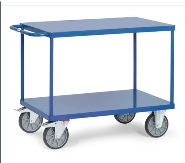
Stahlrohr und Profilstahl geschweißt, pulverbeschichtet RAL 5007. 2 Plattformen aus Stahlblech, bündig im Rahmen, sauber eingeschweißt, ebenfalls pulverbeschichtet RAL 5007. 2 Lenk- und 2 Bockrollen, TPE-Bereifung, Naben mit Rillenkugellager. Feststeller an den Lenkrollen, gemäß der Europäischen Norm EN 1757-3 (Sicherheit von Plattformwagen). Tragkraft obere Ladefläche 200 kg.
