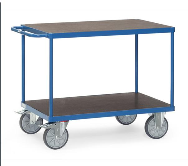
Stahlrohr und Profilstahl geschweißt, pulverbeschichtet RAL 5007. 2 Plattformen mit rutschsicherer Siebdruckplatte aus wasserfestem Sperrholz. 2 Lenk- und 2 Bockrollen, TPE-Bereifung, Naben mit Rillenkugellager. Feststeller an den Lenkrollen, gemäß der Europäischen Norm EN 1757-3 (Sicherheit von Plattformwagen). Tragkraft obere Ladefläche 200 kg.
