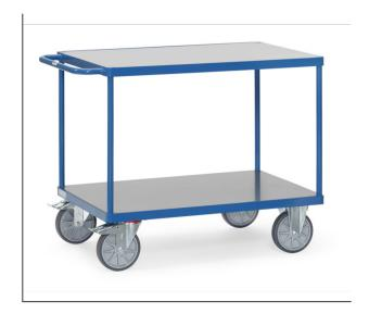
Stahlrohr und Profilstahl geschweißt, pulverbeschichtet RAL 5007. Mlt zwei Plattformen mit Ladeflächen aus Hart-PVC. 2 Lenk- und 2 Bockrollen, TPE-Bereifung, Naben mit Rillenkugellager. Feststeller an den Lenkrollen, gemäß der Europäischen Norm EN 1757-3 (Sicherheit von Plattformwagen). Tragkraft obere Ladefläche 200 kg.
