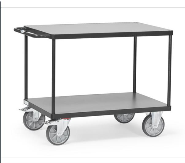
Stahlrohr und Profilstahl geschweißt, pulverbeschichtet RAL 7016. 2 Plattformen aus Holzwerkstoffplatte, Oberfläche mittelgrau. 2 Lenk- und 2 Bockrollen, TPE-Bereifung, Naben mit Rillenkugellager. Feststeller an den Lenkrollen, gemäß der Europäischen Norm EN 1757-3 (Sicherheit von Plattformwagen). Tragkraft obere Ladefläche 200 kg.
