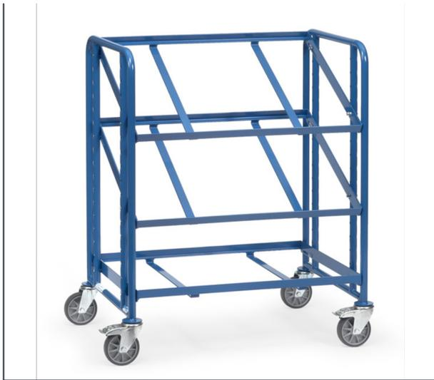
Stahlrohr und Profilstahl-Konstruktion, pulverbeschichtet RAL 5007. Schraubkonstruktion. Etagenrahmen variabel einschraubbar, Raster 50 mm, Neigung bei schrägem Einbau 15° oder 30°. Tragkraft obere und mittlere Ladefläche 60 kg. 3 Etagenrahmen passend für je 1 Eurokasten. 4 Lenkrollen, TPE-Bereifung, Naben mit Rillenkugellager. 2 Stück mit Feststeller, gemäß der Europäischen Norm EN 1757-3 (Sicherheit von Plattformwagen).
