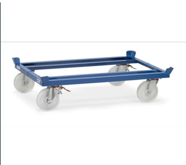
Robuste Winkelstahl-Schweißkonstruktion, mit 4 Fangecken. Pulverbeschichtet blau RAL 5007. 4 Lenkrollen mit Polyamid-Rädern, Naben mit Präzisionskugellager. 2 Lenkrollen mit Totalfeststeller im Vorlauf, diagonal angeordnet. Unterfahrhöhe: 235 mm
