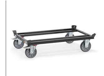
Für Flachpaletten und Gitterboxen. Robuste Winkelstahl-Schweißkonstruktion, mit 4 Fangecken, pulverbeschichtet, schiefergrau RAL 7015. 2 Lenk- und 2 Bockrollen, TPE-ESD-Bereifung, Naben mit Rillenkugellager, Feststeller an den Lenkrollen, gemäß der europäischen Norm EN 1757-3 (Sicherheit von Plattformwagen). Sehr geringer Anfahr-, Roll- und Schwenkwiderstand. Geräuscharmer Lauf auf ebenen Böden. Reifen nicht kreidend (spurlos).
